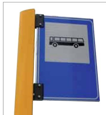
La struttura portante è costituita da un palo estruso di alluminio 6060 T6. Detto profilo, corredato da apposito carter di chiusura, sostiene il pannello di indicazione di fermata delle dimensioni di 40x60 cm e il pannello porta-orari.
