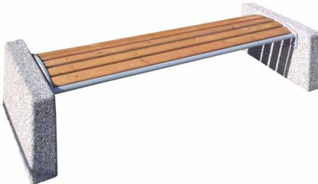
Panchina metallo-legno con fianchi in conglomerato di calcestruzzo composto da cemento e inerte di fiume lavato. E' formata da due spalle laterali in acciaio sp.5mm sagomate con taglio laser, fissate tramite viti ai muretti laterali in conglomerato cementizio di dim.
