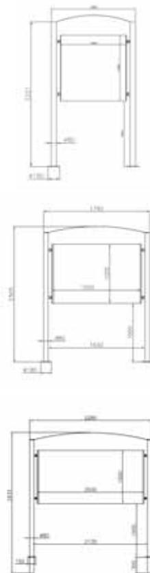
Bacheca composta da due 2 colonne portanti in acciaio con flangia alla base per il tassellamento. Il telaio centrale è costituito da tubolare in ferro al quale viene rivettata una lamiera che servirà da base per l'affissione di manifesti.
