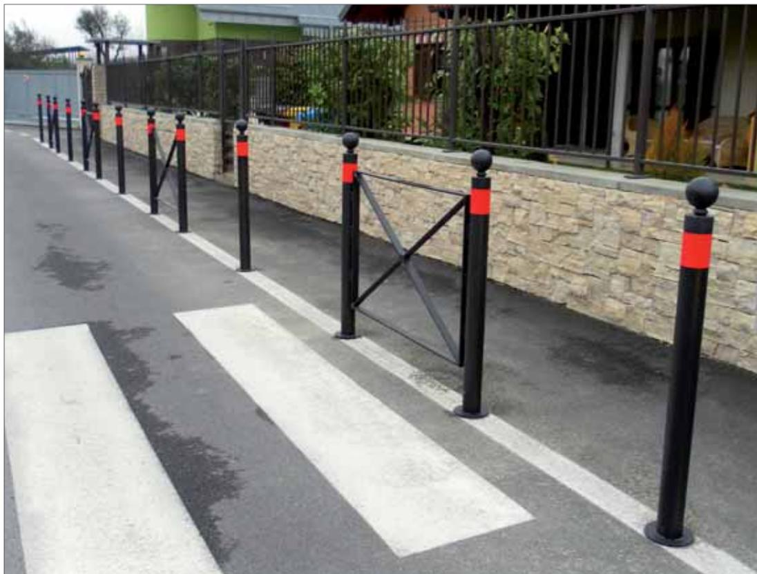
La barriera modello Londra è realizzata da due sostegni in tubolare di acciaio diametro 80x2 con sovrastante borchia Ø40 e sfera Ø90mm in acciaio forgiato e flangia alla base Ø150mm (senza fori come copriforo per la versione da inghisare profondità 200mm o con n.3 fori per fissaggio al suolo tramite tasselli ad espansione).
