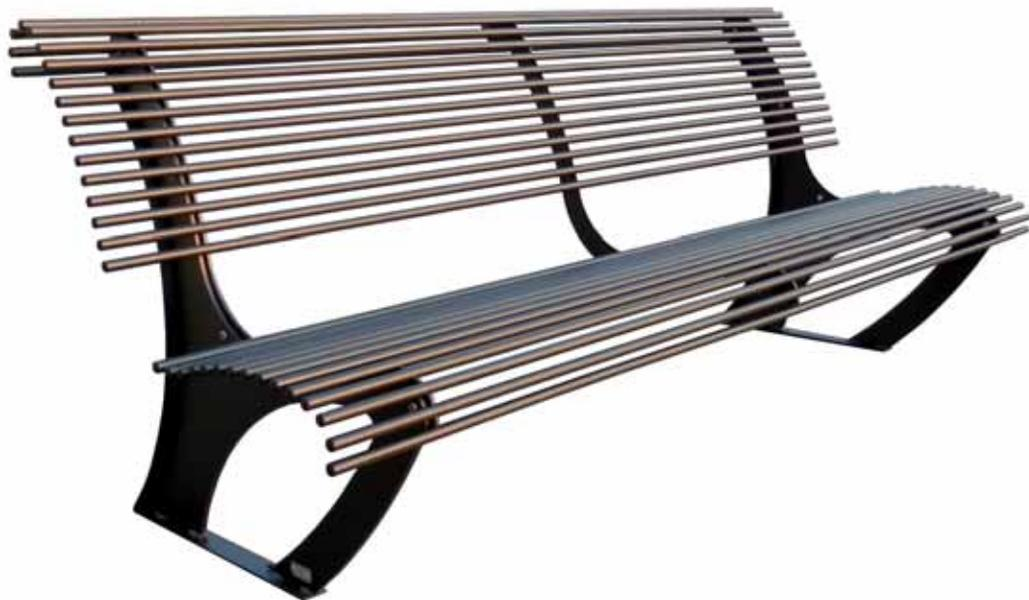
Panchina di particolare forma ergonomica costituita da due robuste spalle laterali sp. 6 mm tagliate con tecnologia laser e ribordata in piatto 40x5 mm saldato nella parte posteriore e inferiore a supportare la seduta.
