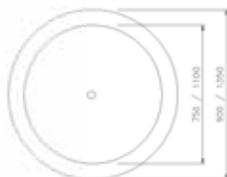
Fioriera in ghisa in unica fusione costituita da un elemento concavo a rilievi concentrici decrescenti a formare un corpo emisferico, dotata di un foro centrale per il deflusso di liquidi in eccesso e sostenuta da tre piedi di forma sferica in ghisa del diametro di 125mm che poggiano direttamente al suolo.
