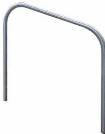
Portabici ad 1-2 posti realizzato mediante piegatura a freddo di tubolare in acciaio D.48. Il portabici viene fornito da inghisare con piastre decorative per coprire il foro o su richiesta con piastra di base da tassellare.
