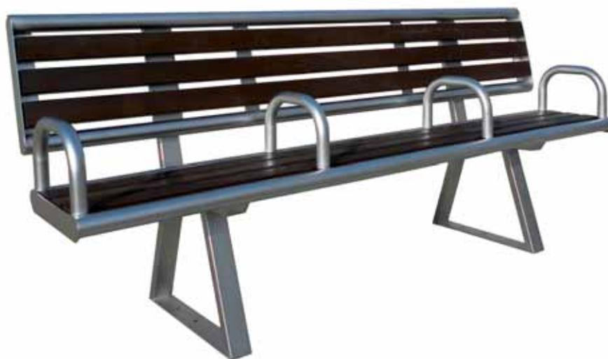
Panchina metallo-legno costituita da due sostegni in tubolare 60x30 mm in acciaio inox ai quali vengono saldati, nella parte inferiore, una piastra per il tassellamento al suolo, mentre nella parte superiore viene saldata una piastra per il fissaggio della seduta e dello schienale.
