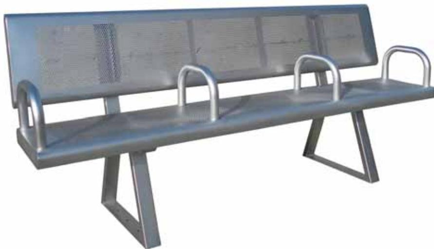
Panchina totalmente in acciaio inox costituita da due sostegni in tubolare 60x30 mm in acciaio ai quali vengono saldati, nella parte inferiore, una piastra per il tassellamento al suolo, mentre nella parte superiore viene saldata una piastra per il fissaggio della seduta e dello schienale. La seduta e lo schienale sono realizzati in lamiera di acciaio inox forata sp.15/10 opportunamente sagomata alle estremità.
