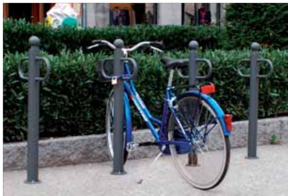
Portabici realizzato con un tubolare di acciaio diam.80 mm con sovrastante sfera decorativa in acciaio forgiato diam.90 mm. Al tubolare diam.80 sono saldate due "maniglie" in tubo tondo sagomato diam.38mm per assicurare la bicicletta.
