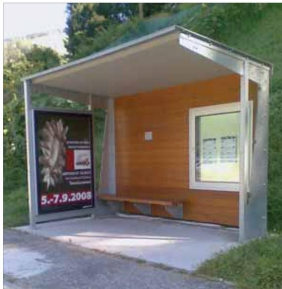
La pensilina Magic bus è composta da montanti e sottostruttura della tettoia in profilati d'acciaio zincato a caldo di spessore di 15 mm; la sottostruttura della parete posteriore e del tetto sono di una tavola a tre strati in abete spessore 48 mm o di profilati d'acciaio rettangolari 65/65/3 mm. Tutti gli spigoli vivi sono arrotondati.
