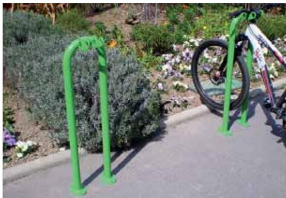
Portabici da un posto realizzato con elemento portante in tubolare diametro 48mm sagomato ad arco a cui sono saldate due flange prodotte da taglio laser sp.5mm che fungono da appoggio per manubrio della bicicletta da assicurare.
