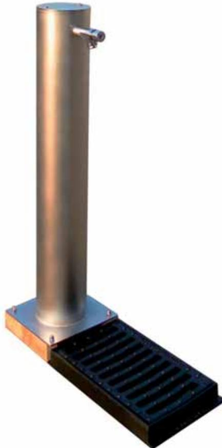
La fontana Inox è costituita da una struttura in tubolare d'acciaio inox tondo D.152 mm alto 1000 mm chiusa nella parte superiore da un tappo in acciaio fissato con due viti per poter essere rimosso con facilità per le operazioni di installazione e manutenzione del rubinetto.
