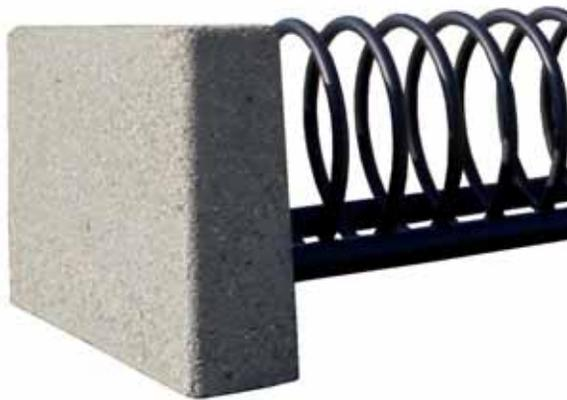
Il portabici è costituito da un elemento a spirale fatto con tubo diam.22mm saldato a due tubolari orizzontali tondi in acciaio diam. 48 mm. Alle estremità dei tubolari orizzontali sono saldate le doppie staffe in piatto 50x5 opportunamente forate per il fissaggio ai muretti laterali di sostegno in calcestruzzo sabbiato dim.730x130xh.410 (predisposti con boccole filettate M12) tramite viti TE M12x25 inox mascherate sotto coperchio metallico.
