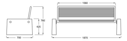
Panchina con struttura in tubo di acciaio non legato Ø35 mm, spessore 2,5 mm e piatti in lamiera decapata di acciaio non legato, spessore 4 mm. Ancorano la struttura 2 fianchi a sezione trapezoidale in calcestruzzo vibrato con spigoli arrotondati. Seduta e schienale a grigliato in tondino di acciaio non legato Ø8 mm.
